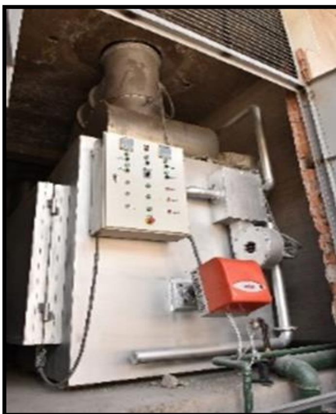
Figura 6. Instalación y funcionamiento del incinerador para los residuos biocontaminados.
